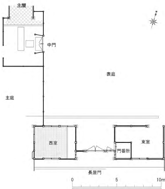
図 2-15、長屋門・中門 平面図（修理前）
