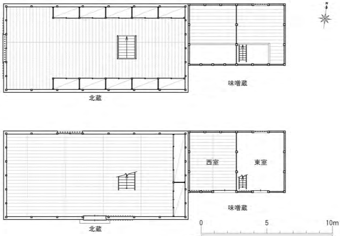
図 2-20、北蔵・味噌蔵 平面図（修理前） 上：二階平面図 下：一階平面図
